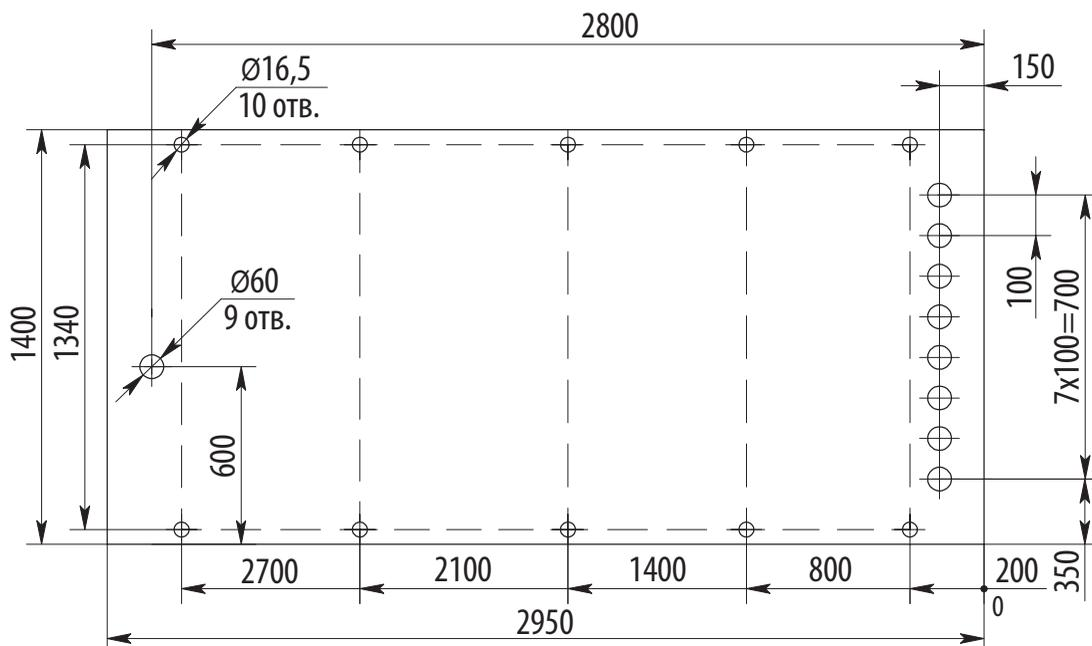
**Разметка отверстий в КТПТАС (с воздушным вводом) мощностью 400 кВ·А для крепления на фундаменте и ввода кабелей НН**
