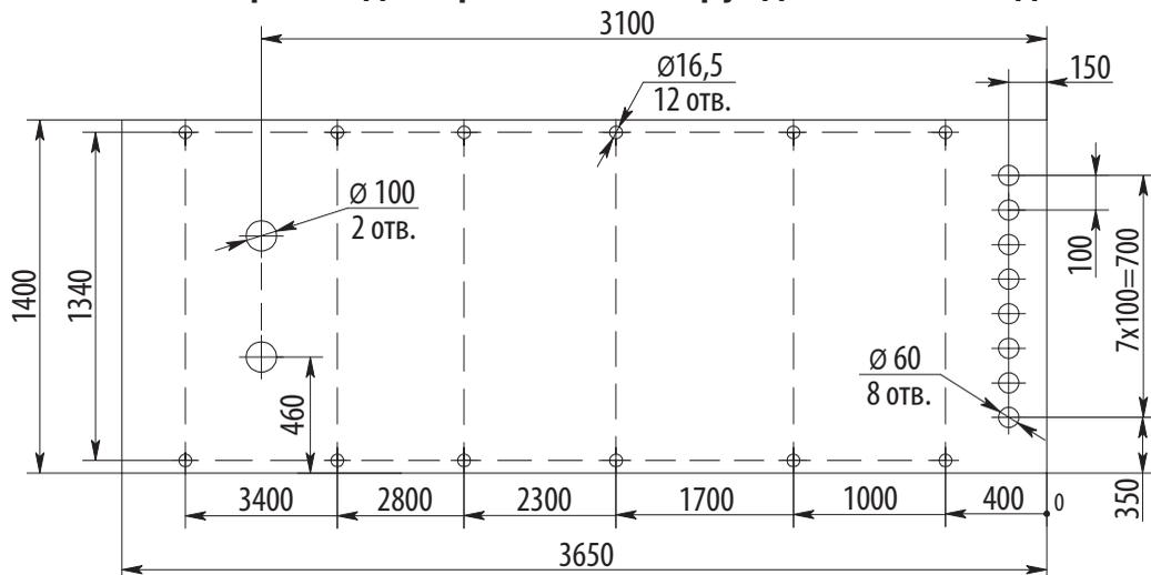
**Габаритные размеры и масса КТПАС мощностью 63...250 кВ·А
