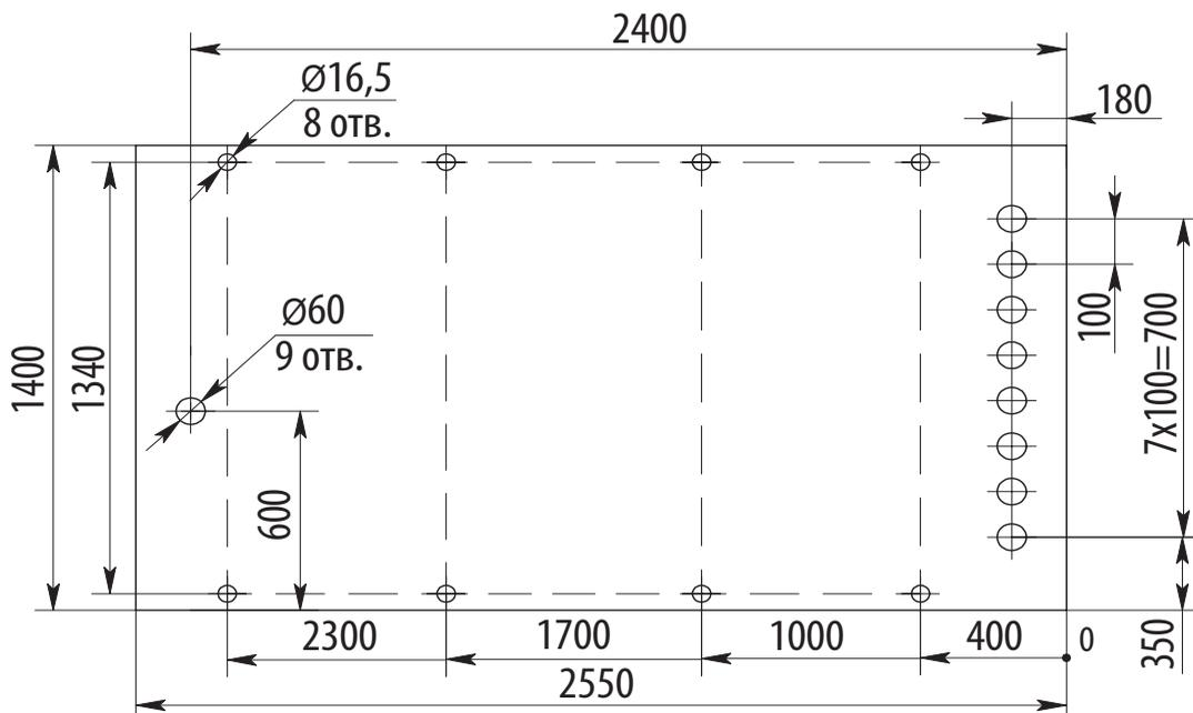
**Разметка отверстий в КТПТАС (с воздушным вводом) мощностью 63...250 кВ·А для крепления на фундаменте и ввода кабелей НН**
