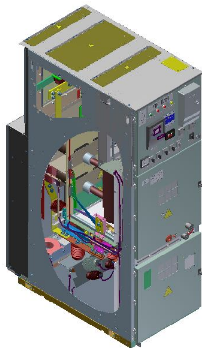
Рисунок 4 – КРУ-МЭТЗ-10-14 двухстороннего обслуживания на токи свыше 1600 А
