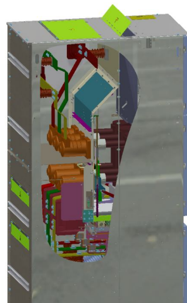
Рисунок 11 – Откидная крышка и сборные шины шкафа одностороннего обслуживания
