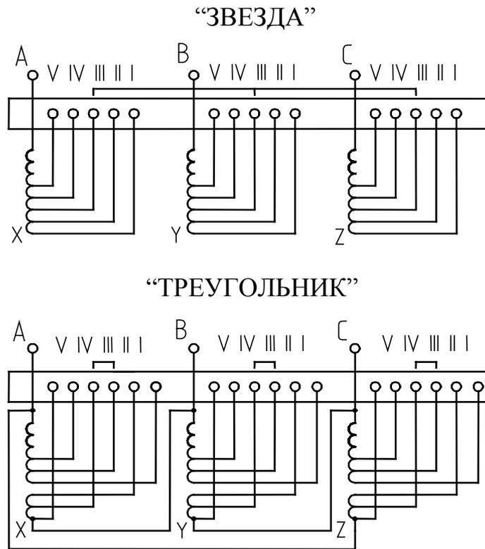
Рисунок 12 - Схема подсоединения ответвлений обмоток ВН к переключателю с диапазоном регулирования напряжения  $\pm 2 \times 2,5 \%$  трансформаторов мощностью 16-630 кВ·А
