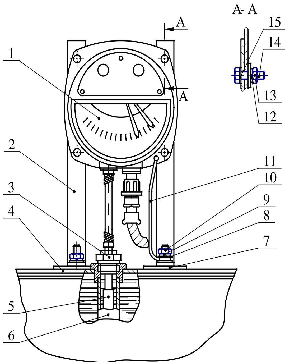
1- манометрический термометр; 2 - уголок; 3 - зажимная гайка;
