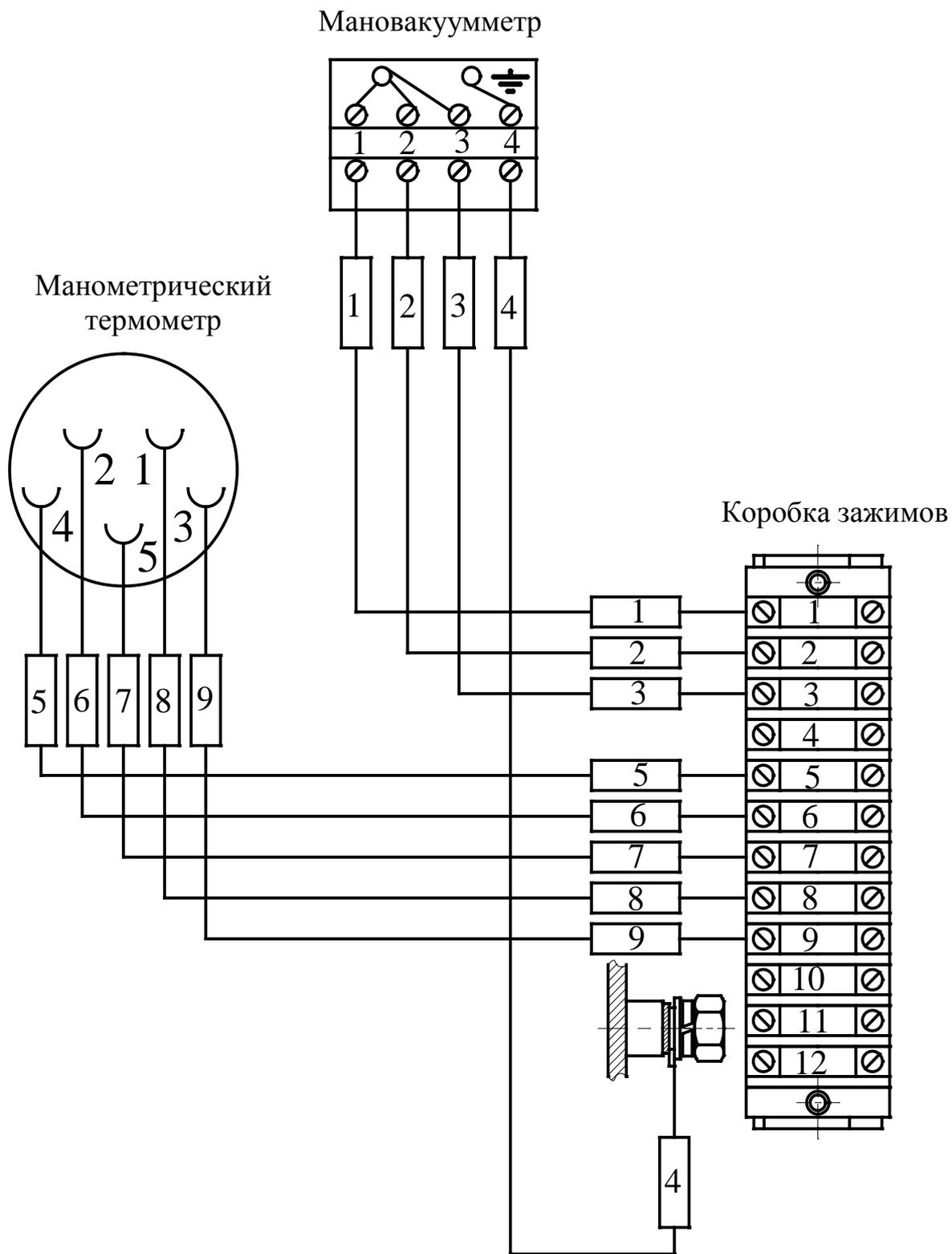
Рисунок 17 – Монтажная схема соединения коробки зажимов с контрольно-измерительными приборами
