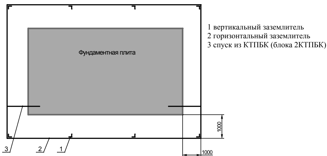
Рис. Д.1. Заземляющее устройство КТПБК (2КТПБК)
