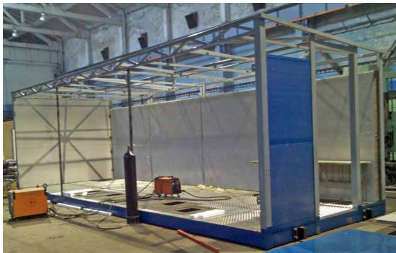
Конструкция блок-контейнера, исключая образование «мостиков холода»
