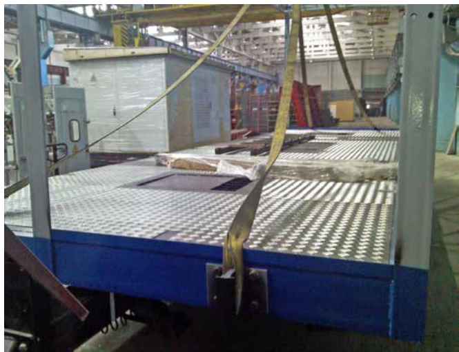
Конструкция блок-контейнера, исключая образование «мостиков холода»
