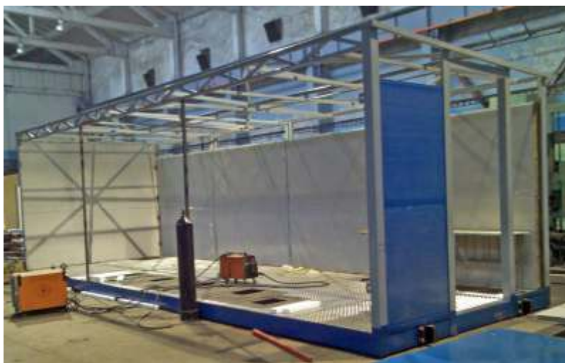
Конструкция блок-контейнера, исключая образование «мостиков холода»
